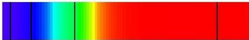
Figuur 3: Het spectrum van waterstof in zichtbaar licht. De lijn in het rood is de H- \alpha lijn.
